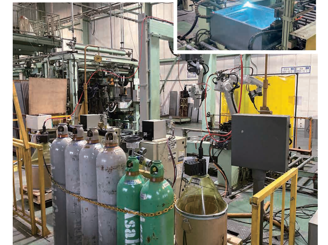
アルゴンによる溶接
